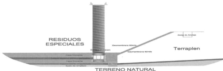
Se colocará doble recubrimiento de geomembrana de 60mils, la primera capa va en la cota batea del tubo del subdren y la segunda en la cota batea del filtro de lixiviados.
